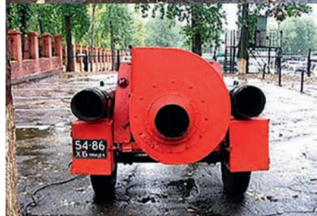
▲ Рис. 7. Дымосос на базе МП-1600
