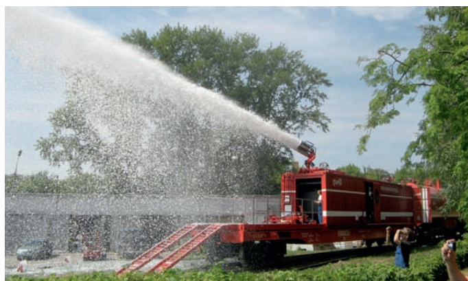
▲ Подача огнетушащих пен от автономного пожарного модуля на железнодорожной платформе
