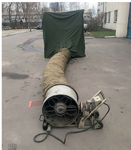
▲ Рис. 15. Перемычка с дымососом ДПЭ-15 и воздушным рукавом. Комплект в сборе
