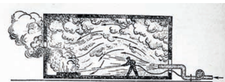
▲ Рис. 18. Схема работы дымососа на нагнетание чистого воздуха в помещение (стрелками обозначено направление движения чистого воздуха)
