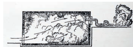
▲ Рис. 19. Схема работы дымососа на отсос продуктов горения из помещения (стрелками обозначено направление движения чистого воздуха)
