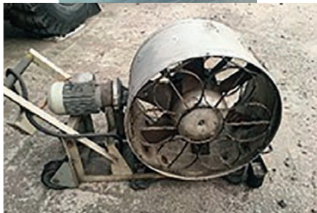
▲ Рис. 12. Дымососы ДП-7 с различными приводами (бензиновым, электрическим и водяным)
