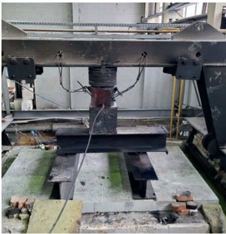
▲ Рис. 4. Железобетонная плита до начала испытаний
